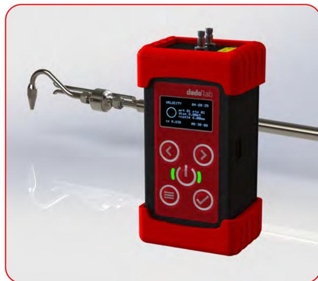
La linea QB1e si può sincronizzare con il misuratore di velocità e portata Dado Lab Mod. ST2, permettendo il campionamento isocinetico manuale.
